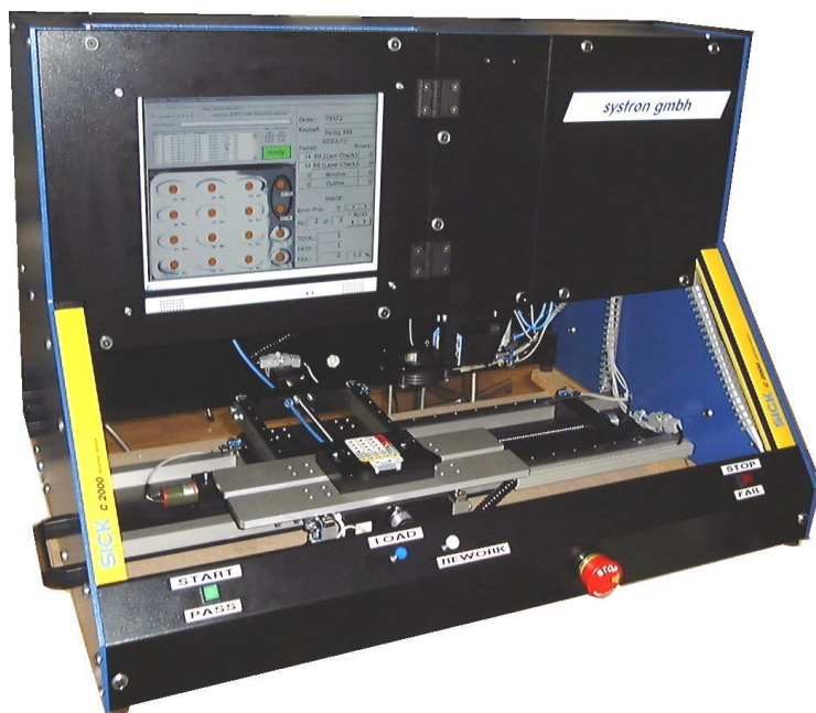
Tisch-Anlage mit präzisiertem, XY-Positionier-Kreuztisch. (< 0.1 mm)
